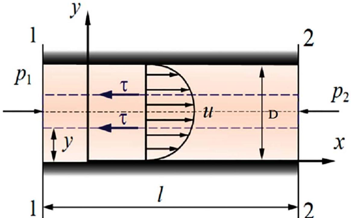
Рисунок 1 – Схема к определению расхода жидкости в ламинарном потоке
