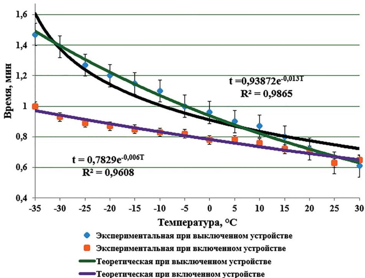
Рисунок 3 – Зависимость времени подъёма кузова
