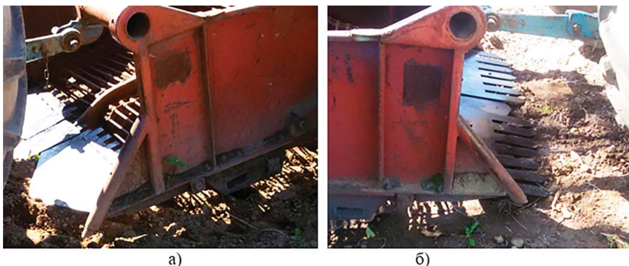
а) – серийный; б) – пальцевый, с пальцами одинаковой длины, заточенными под углом 30°
