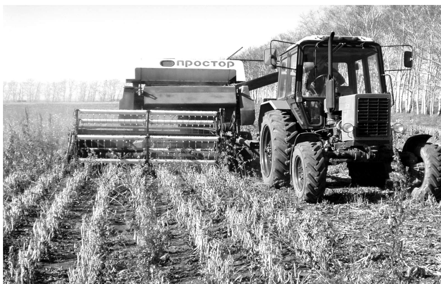
Рис. 4. Уборка фасоли сорта Щедрая комбайном ПН-100 «Простор» в агрегате с трактором МТЗ-82 (ОПХ ВНИИсои, 2006 г.)
