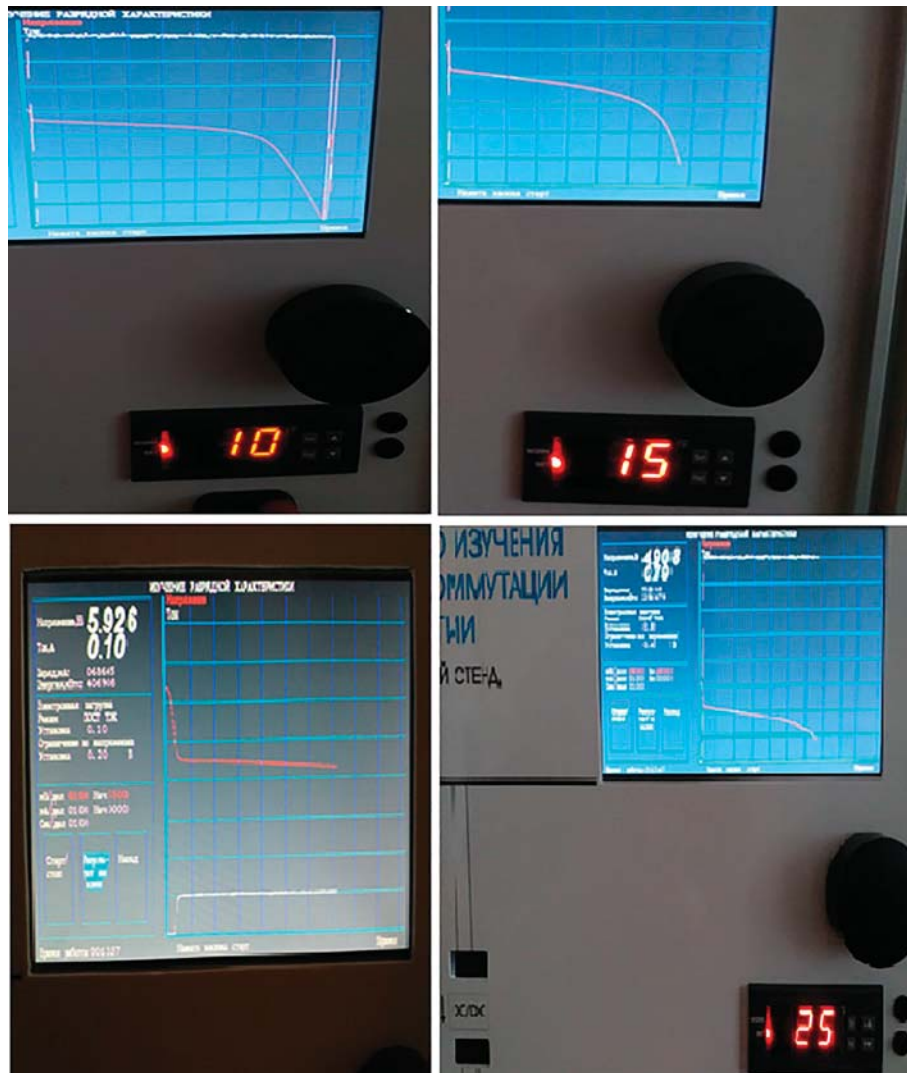
Рисунок 2 – Экспериментальные исследования временных характеристик процесса разряда свинцовой аккумуляторной батареи при различных значениях тока разрядки и температуре
