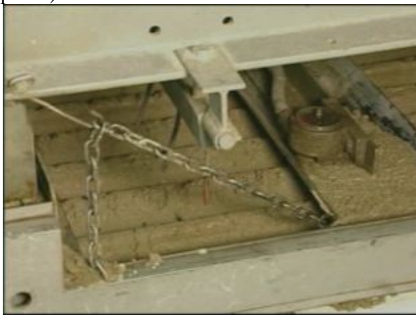
Рис.4. Уплотнение бетонной смеси трамбуемым устройством
