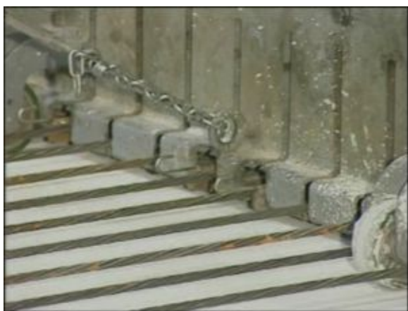
Рис. 2. Конструкция натяжной машины типа «кролик»
