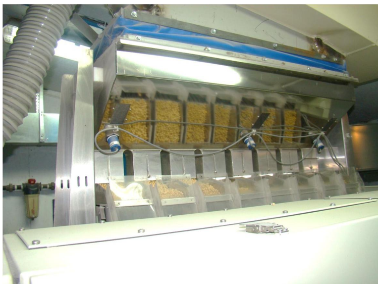
Рис. 2. Разделение сои по цвету оболочки и рубчика на установке SATAKE
