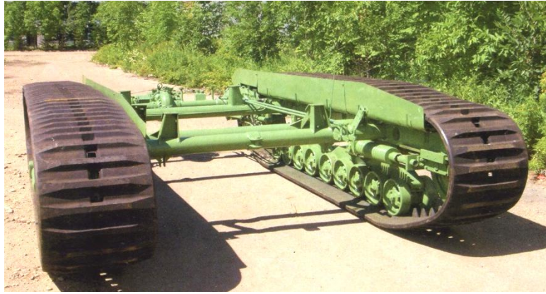
Рис. 6. Перспективная гусеничная ходовая тележка (ГХТ) типа ТГР-3 на резиноармированных гусеницах 645×125×82 производства японской фирмы «Bridgestone» для машин высокой проходимости, предлагаемая ЗАО «БКЗ «Дальсельмаш» (г. Биробиджан)
