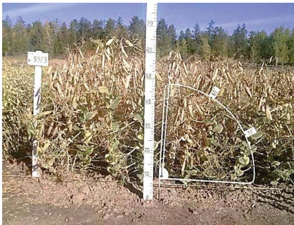
Рис. 2. Прибор для определения степени полегаемости
