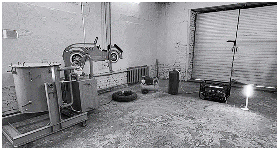
Рисунок 4 – Проверка автономной когенерационной линии на пиролизной технологии
