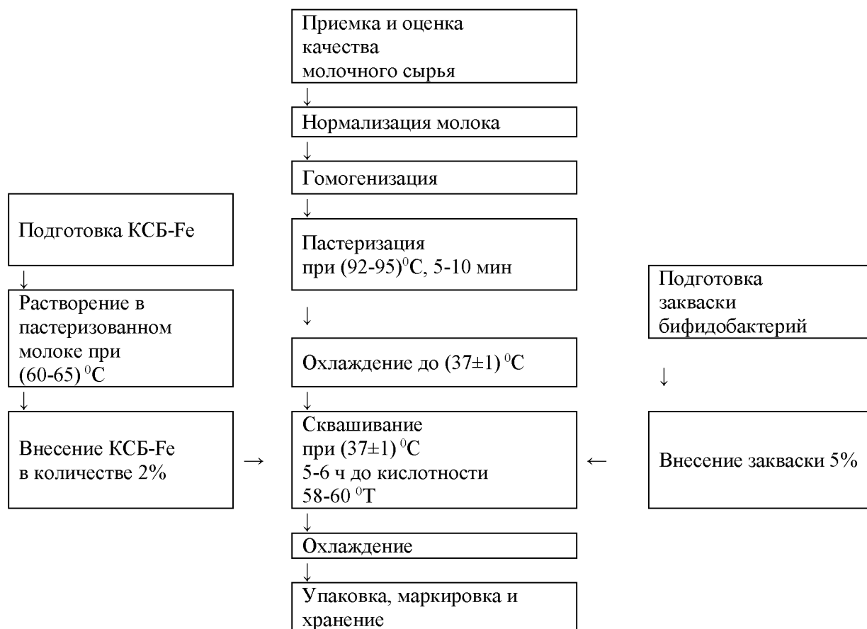
Рис. 3. Технологическая схема производства кисломолочного продукта, обогащенного железом
