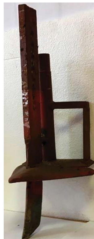
Фиг. 1) вид сбоку; Фиг. 2) вид снизу 1 – лапа культиватора; 2 – стойка-щелеватель; 3 – башмак; 4 – крепежная пластина; 5 – разбрасыватель; 6 – ножи; 7 – трубка-семяпровод
