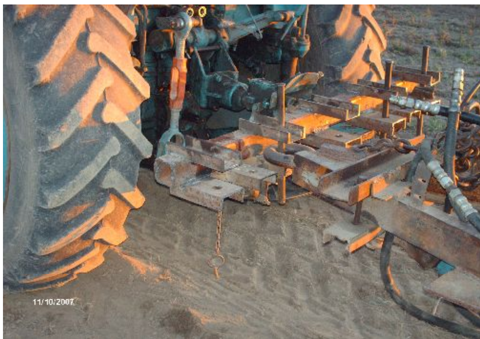
Рис.5. Фрагменты испытаний по расположению точки прицепа
