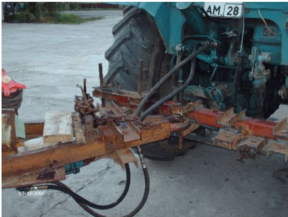
Рис.11. Фрагменты испытаний по углу слома рамы прицепа
