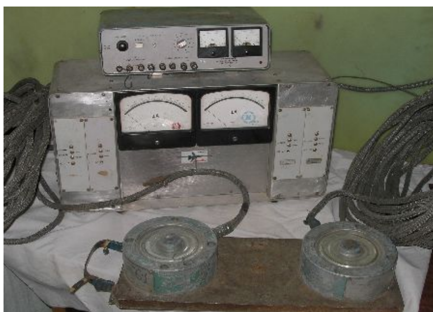
Рис. 4. Соединение тензорезисторов с преобразователем сигнала
