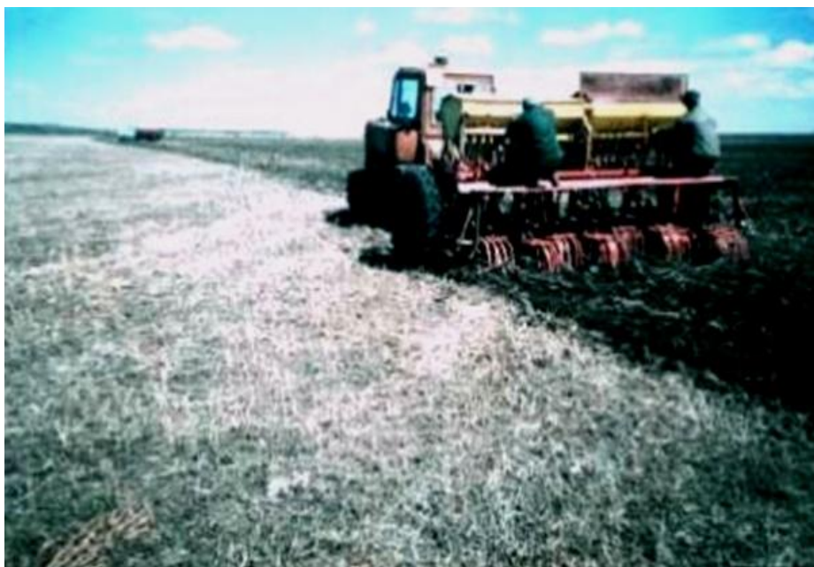
Рис. 2. Машина многофункциональная универсальная (ММУ-3,6) на прямом посеве зерновых по соевой стерне
