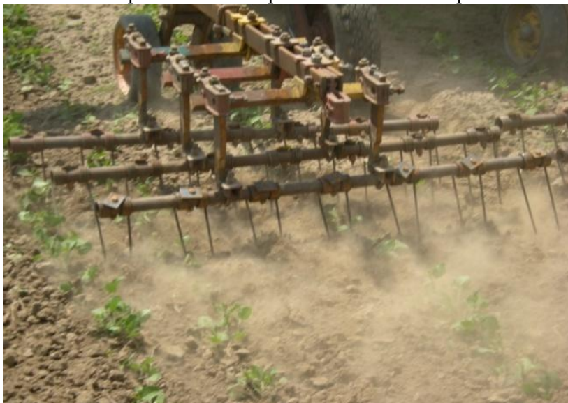
Рис. 3. Секция бороны (БПРЗ-1,2) на боронование посевов сои
