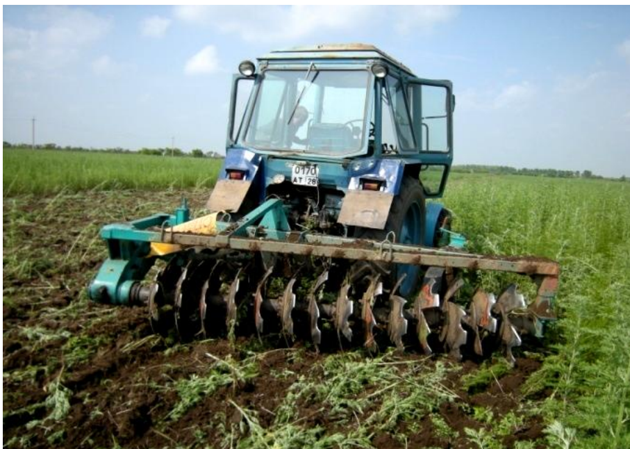
Рис. 1. Орудие для воспроизводства плодородия почвы (ОВПП-2,4) на обработке почвы с заделкой зелёной массы в верхний слой 0 – 12 см (сидеральный пар из сорняков)
