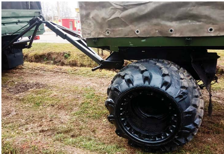
Рисунок 4 – Работа тягово-сцепного устройства и нагрузка дышла прицепа
