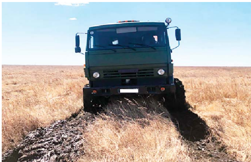
Рисунок 8 – Фрагмент прохода по полю автомобиля на арочных шинах
