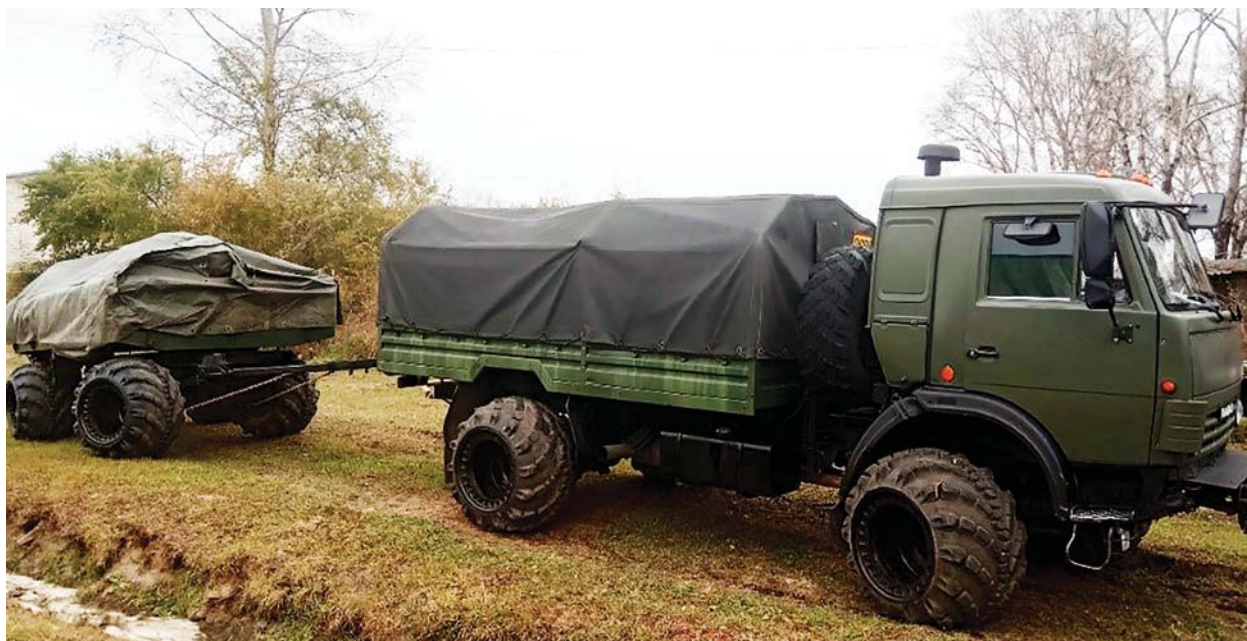
Рисунок 2 – Автомобиль КамАЗ-4350 с установленным догружающим модулем для грузового автомобиля и прицепом ПН-4М на арочных шинах в ходе проведения транспортной операции
