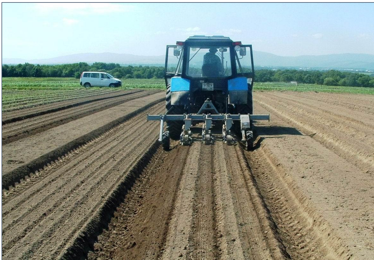
Рис. 2. Посев овощей на гряде 1,8 м сеялкой СТВ – 5
