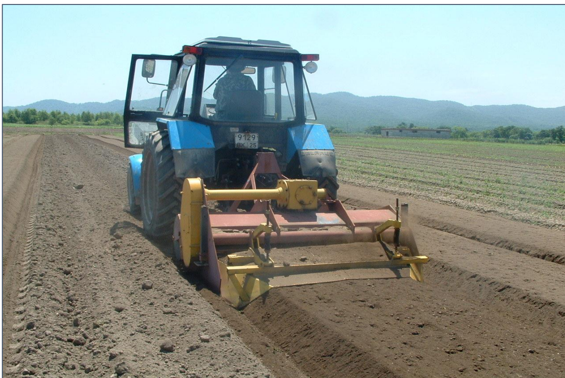
Рис. 3. Гребнеобразователь ГФН – 1,8 при формировании гряд
