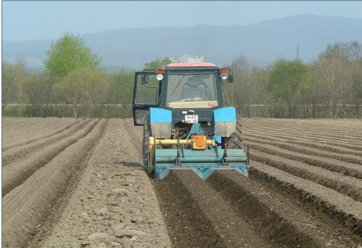
Рис. 1. Гребнеобразователь ГФН – 1,8 при формировании гребней
