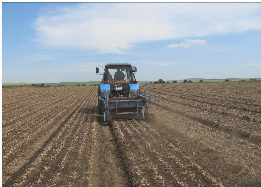
Рис. 4. Ботворез БЛ – 3 в работе
