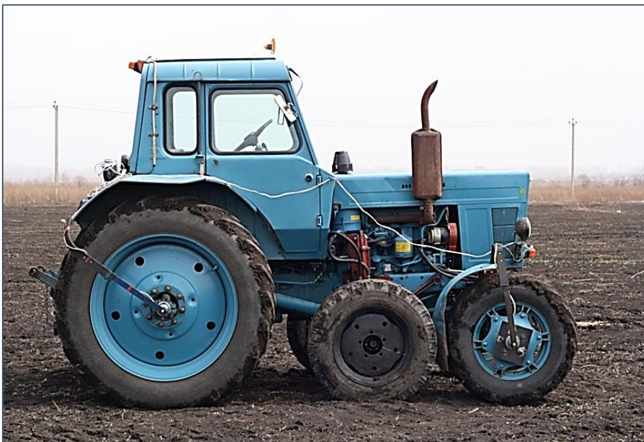
Рис. 3. Трактор класса 1,4 с дополнительным ведущим мостом
