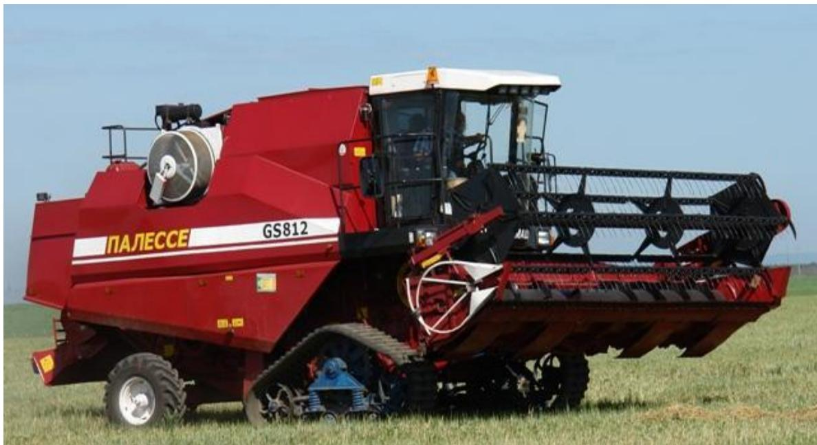
Рис. 4. Зерноуборочный комбайн на полугусеничном шасси с РАГ
