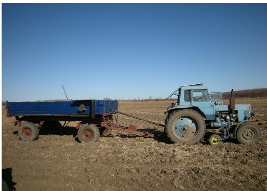
Рис. 3. Общий вид трактора и прицепа с центробежными дисбалансами
