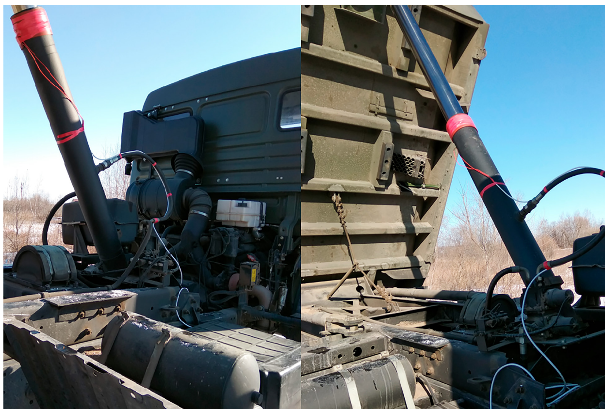
Рисунок 2 – Автомобиль КамАЗ-55111 с установленным подогревающим устройством гидроцилиндра подъёма кузова
