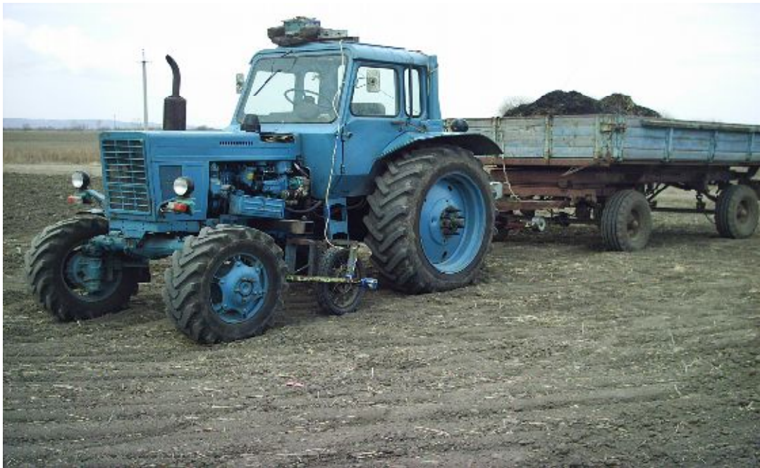
Рис. 5. Трактор и прицеп 2ПТС-4 с корректором сцепного веса
