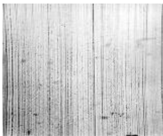
Рис. 6. Вид рабочей поверхности вкладыша АО-20-01 после 25 часов испытаний на масле
