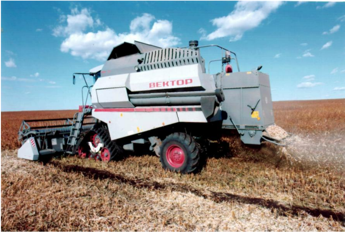
Рис. 10. Зерноуборочный комбайн «Вектор-420» на полугусеничном движителе с РАГ
