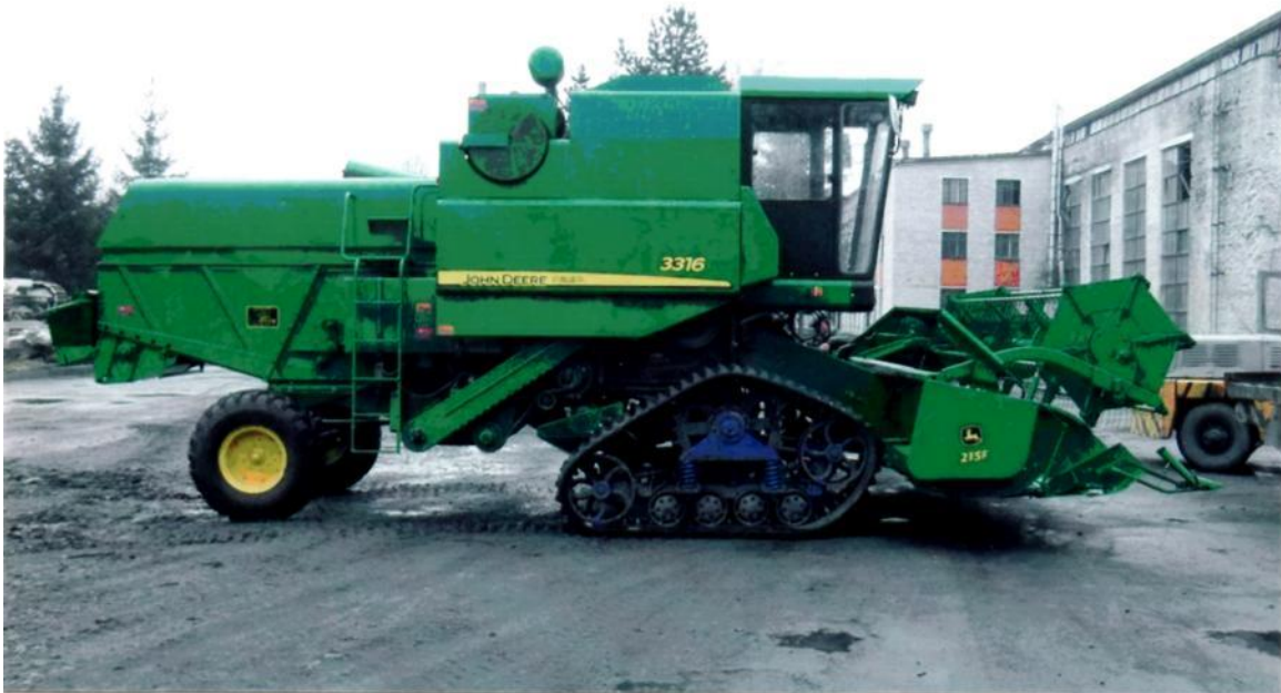
Рис. 11. Зерноуборочный комбайн «John Deere 3316» китайского производства на полугусеничном движителе с РАГ
