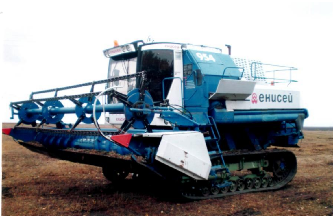
Рис. 9. Зерноуборочный комбайн «Енисей- 954» резиноармированными гусеницами (РАГ)
