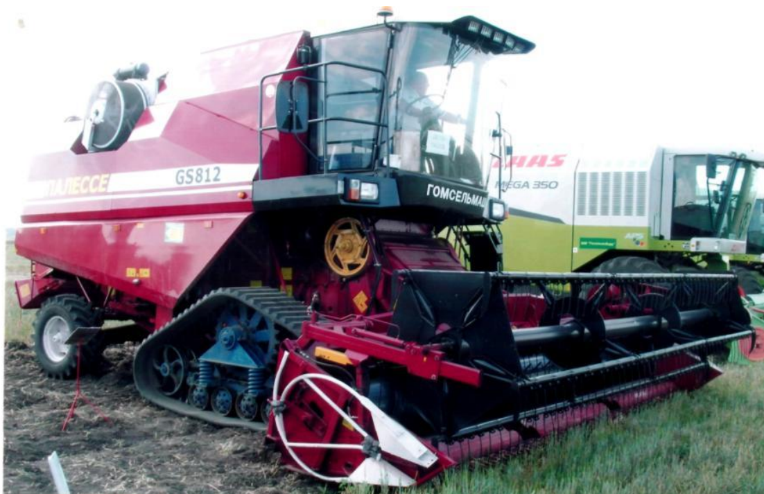
Рис. 8. Зерноуборочный комбайн «Поселье GS 812» на полугусеничном движителе с РАГ
