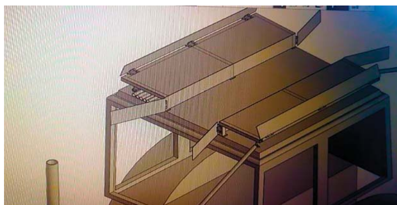
Рисунок 2 – 3D-модель автономного модуля для хранения техники на крыше кабины трактора МТЗ-82
