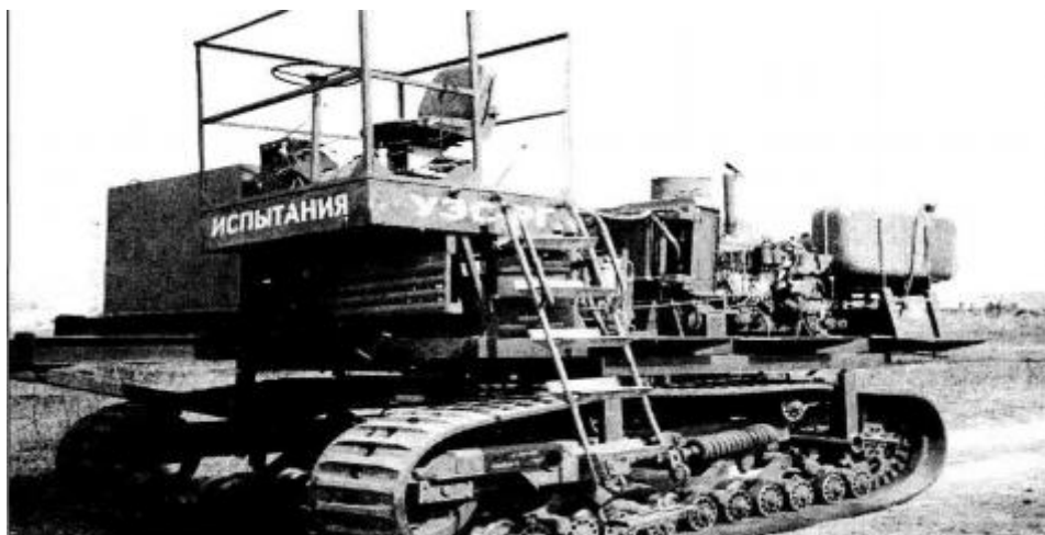
Рис. 4. Универсальное энергетическое средство на резиноармированных гусеницах
