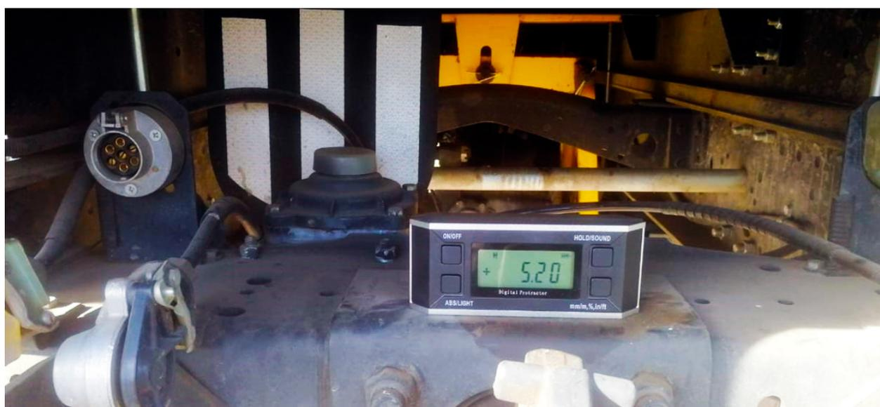
Рисунок 3 – Инклинометр Absolute Digital Protractor
