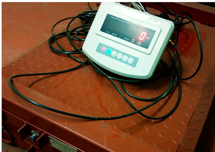
Рисунок 2 – Весы платформенные электронные МВСК(В)
