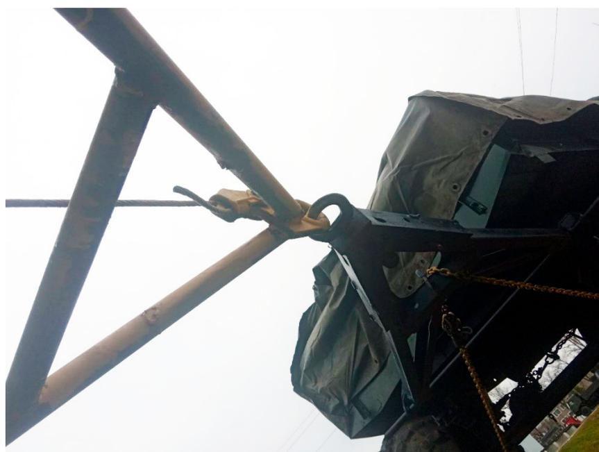
**Рисунок 3 – Догружающий модуль для грузового автомобиля**
