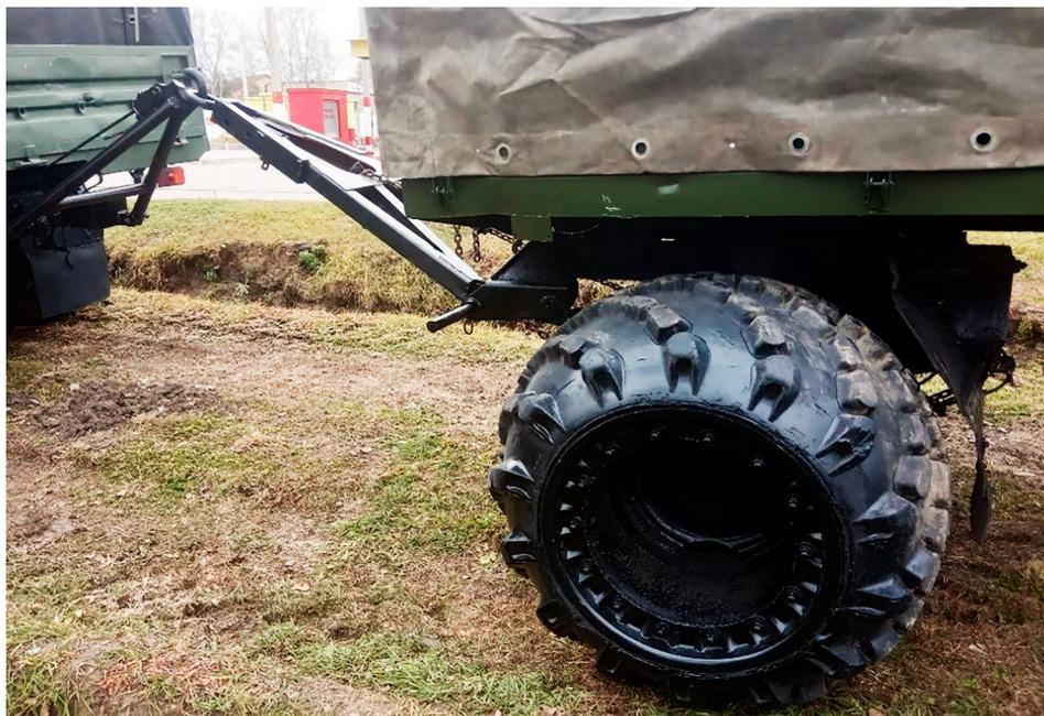
**Рисунок 4 – Работа тягово-сцепного устройства и нагрузка дышла прицепа**
