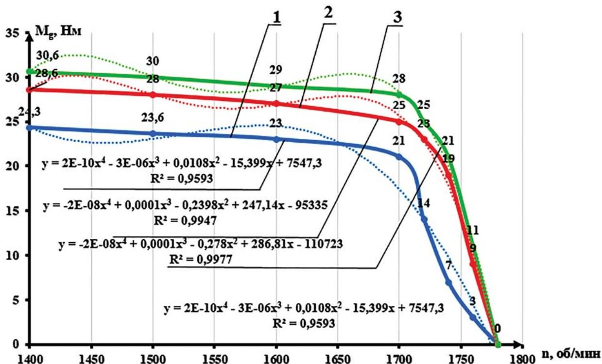
1 – крутящий момент серийного двигателя, работающего на дизельном топливе; 2 – крутящий момент экспериментального двигателя, работающего на газодизельной смеси; 3 – крутящий момент экспериментального двигателя, работающего на газодизельной смеси с дополнительной подачей воздуха
