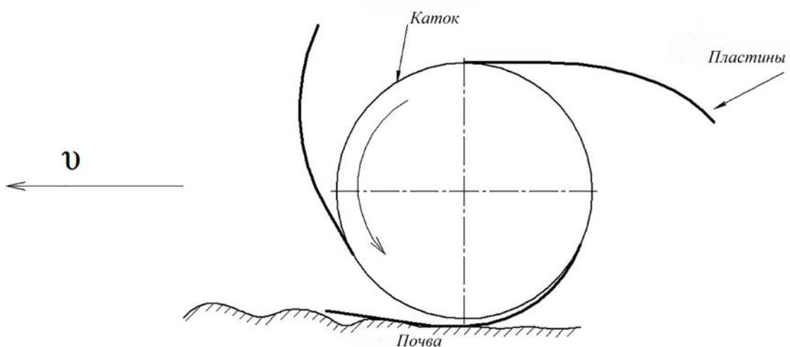
Рисунок 3 – Схема прикатывающего рабочего органа с гибкими пластинами
