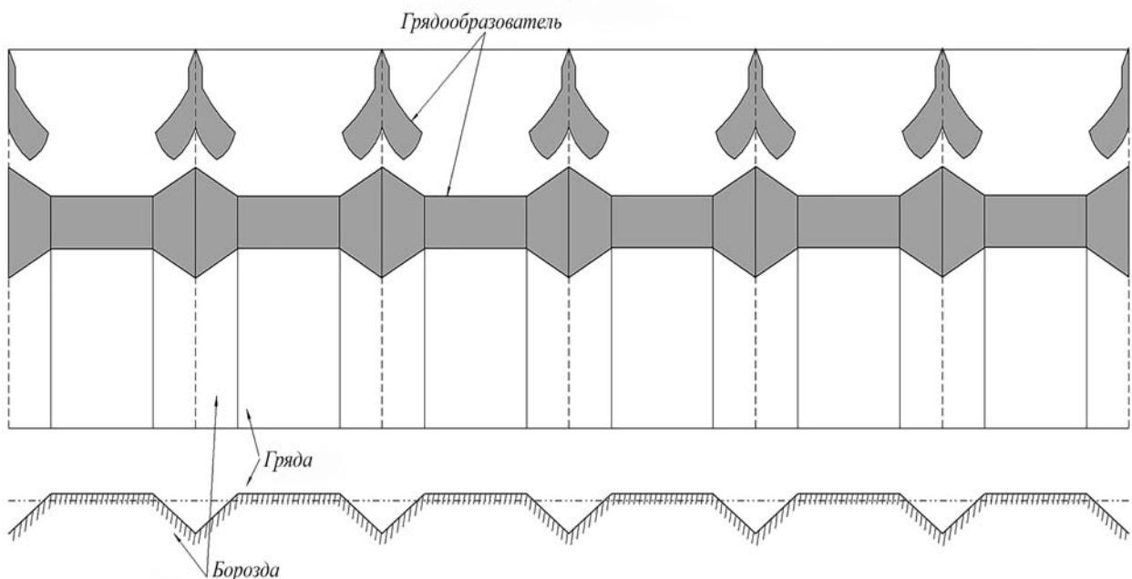
Рисунок 2 – Схема формирования гряд при помощи грядообразователя
