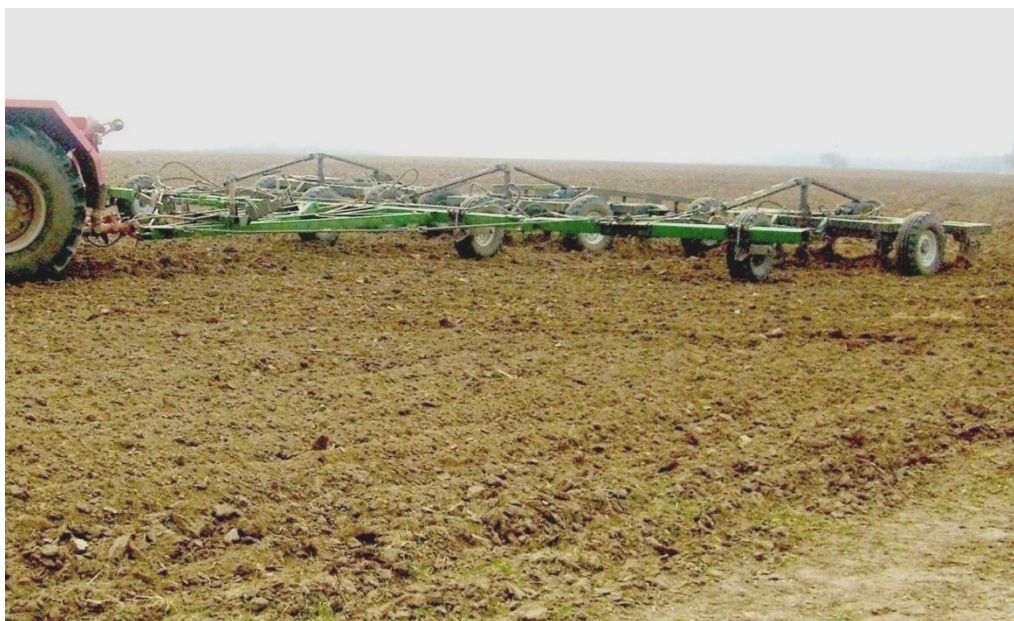
Рис.3. Почвообрабатывающий агрегат К-744Р3+СП-12+3КП-4
