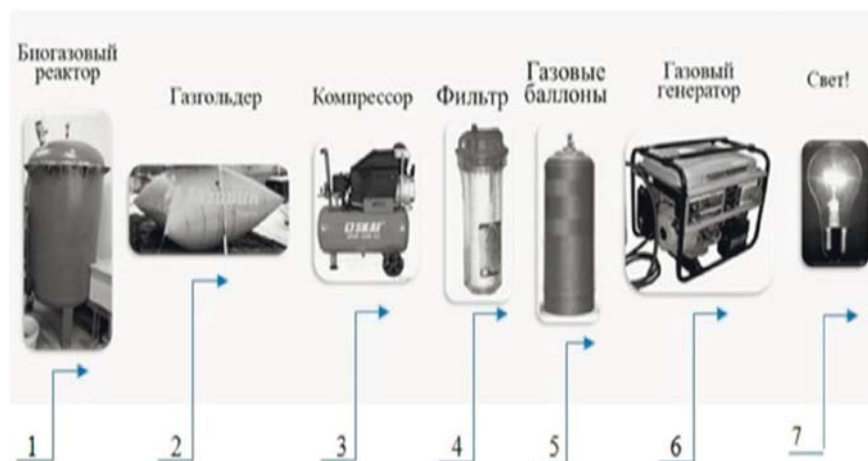
Рис. 1. Принципиальная схема лабораторной биогазовой линии
