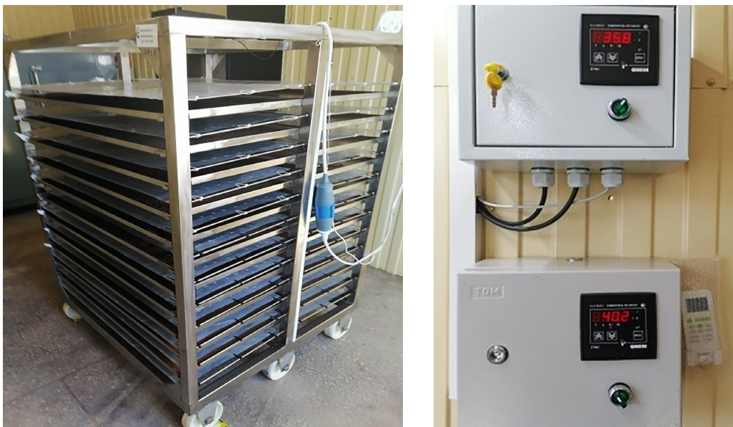
Рисунок 4 – Разработанная сушильная установка для сушки жидких материалов Figure 4 – Developed drying plant for drying liquid materials
