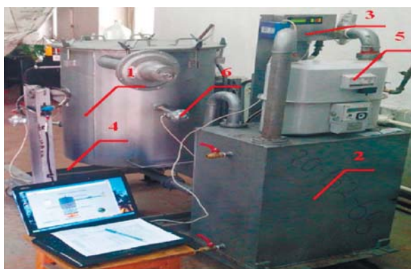
Рис. 2. Пиролизная установка ГВА-1:
