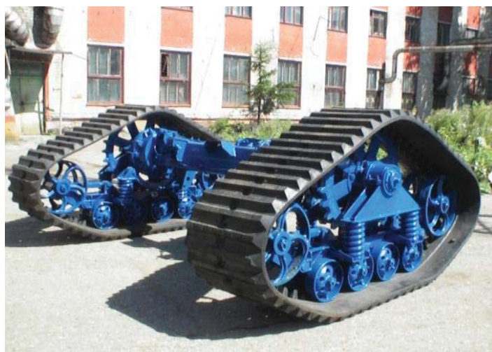
Рис.8. Шасси полугусеничное с резиноармированными гусеницами на мосту МПП для комбайна «Енисей-950»
