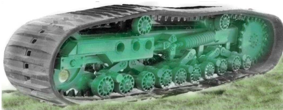
Рис. 6. Гусеничная ходовая тележка на упругой торсионно-балансирной подвеске
