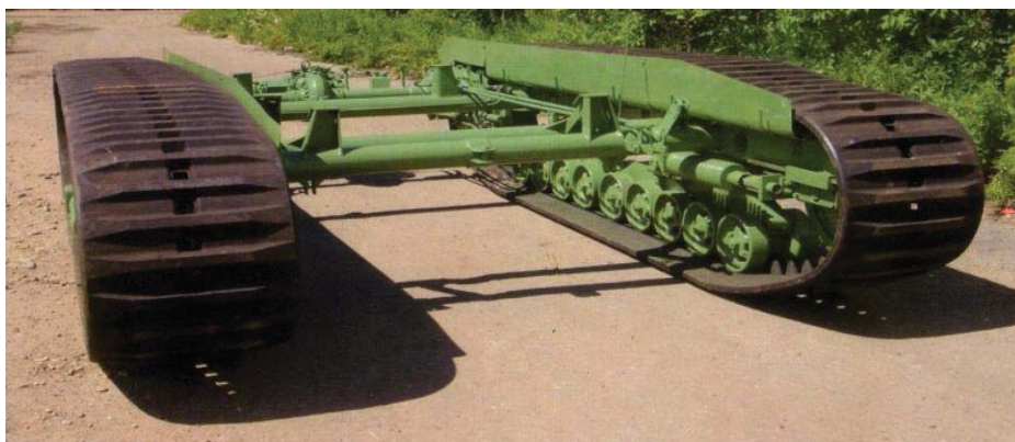
Рис. 5. Гусеничная ходовая тележка на полужёсткой рычажно-пружинной подвеске
