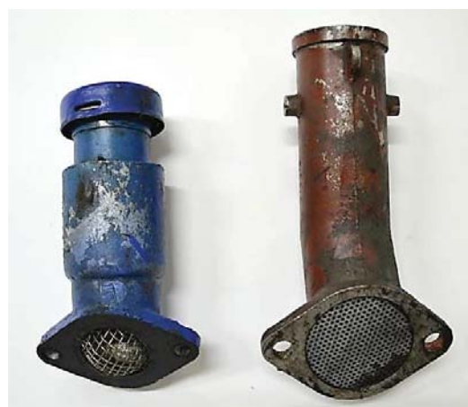
Рис.1. Примеры исполнения маслозаправочных горловин и фильтроэлементов в них: слева направо – горловины двигателей Д-240 и А-41.
