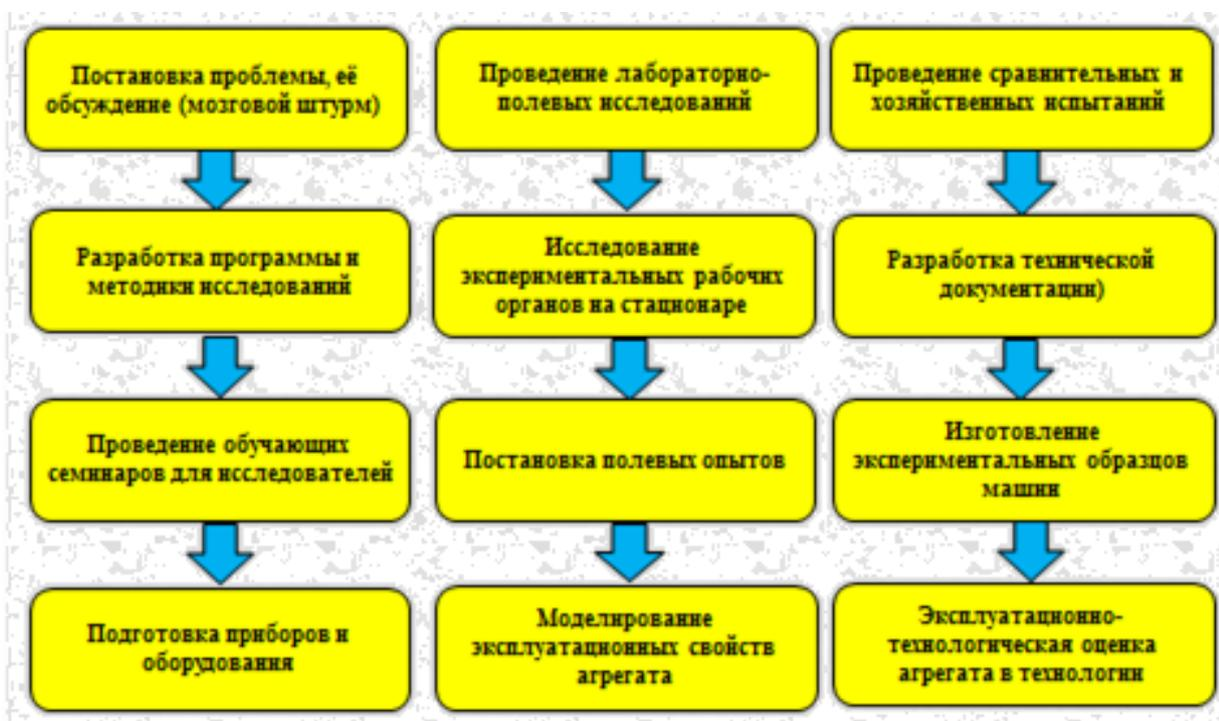
Рис. Общая методология планирования и проведения испытаний машин
