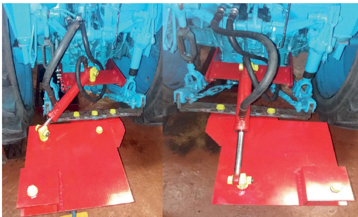
Рис. 1. Общий вид и установочные режимы устройства для снижения радиуса поворота прицепа.
