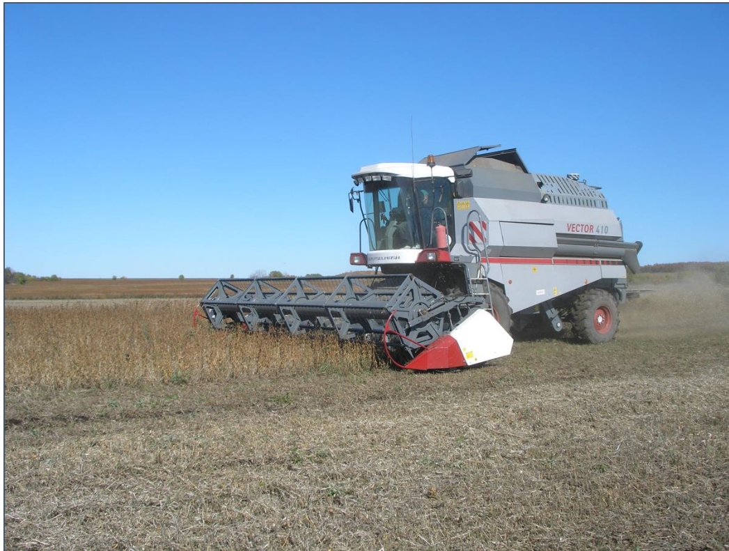
Рис. 1. Жатка соевая унифицированная ЖСУ-700 в агрегате с комбайном РСМ-101 «Вектор 410» на уборке сои
