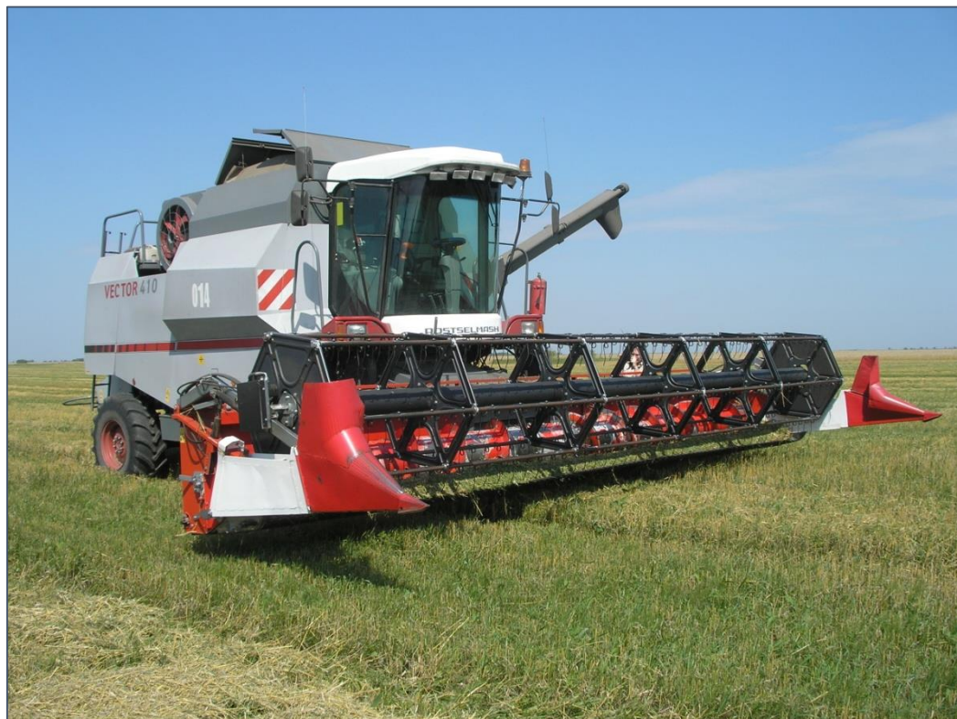
Рис. 2. Жатка соевая TS 90.5.7600 производства итальянской фирмы DBFENERGY в агрегате с комбайном РСМ-101 «Вектор 410», вид спереди, справа (аналог)
